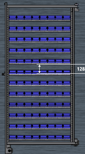
12 Wannen mit 150 mm Achsmaß (je 128 mm Nutzhöhe)
