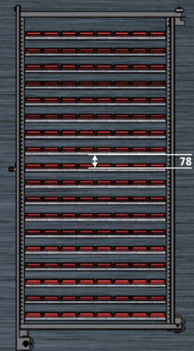
18 Wannen mit 100 mm Achsmaß (je 78 mm Nutzhöhe)
