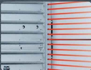
Das Höhenmessgitter ermittelt bei jedem Verfahrensvorgang automatisch die aktuelle Füllhöhe des Tablars
