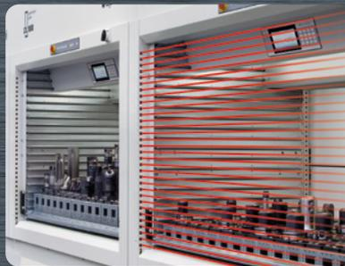
Die Sicherheitslichtschranke schützt die Maschine und das Personal vor Bedienungsfehlern
